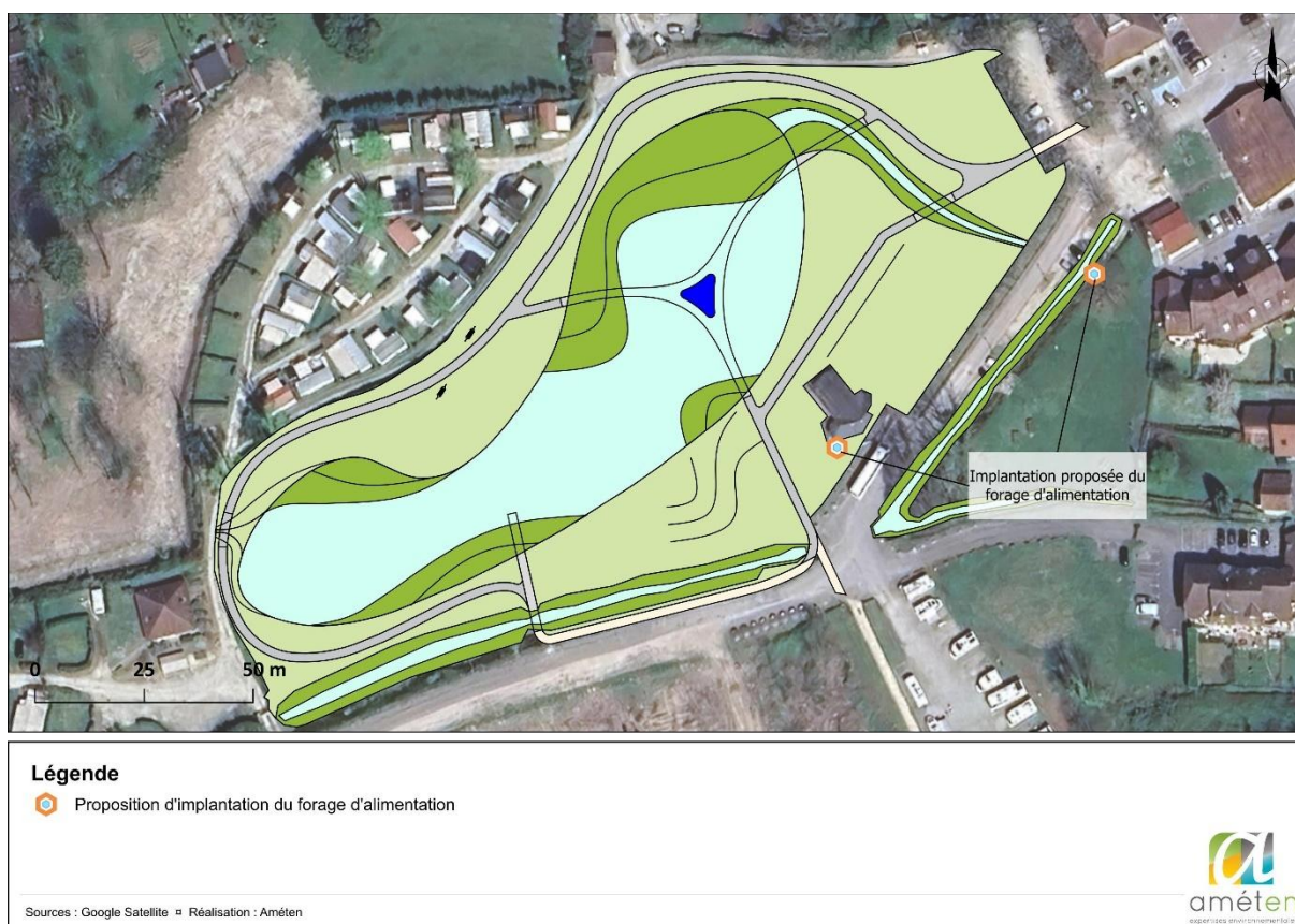
Figure 21: Proposition d'implantation du forage d'alimentation
